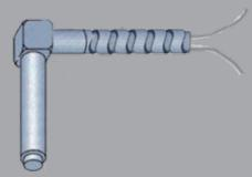
Патронный нагреватель с высокой плотностью мощности AP/DC был разработан для использования в производстве литья под давлением с орячей камерой. Они выпускаются с угловым блоком квадратного сечения, приваренного к нагревателю и встроенной термопаре.
