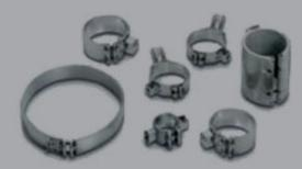
Сопротивления с корпусом из листового металла, стали с алюминиевыл покрытием или нержавеющей стали. Со слюдяной или керамической изоляцией. Отличная теплопередача на цилиндр, однородность нагреви высокая механическая прочность. Рабочая температура: до 300°С дл слюдяной изоляции и до 500°С для керамической изоляции.
