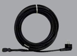
настроенным для включения при температуре 5°С и для выключения при 15°С, имеет холодный кабель длиной 4 м и штепсельную вилку для соединения; саморегулирующийся кабель с полупроводниковой матрицей, который можно резать по размеру соединять и ответвлять. Он не образует опасный перегрев, даже в местах наложения друг на друга, образует мощность, которая сниждется при повышении температуры возлуха на улише
