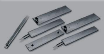
Сопротивления с корпусом из листового металла, стали с алюминиевым покрытием или нержавеющей стали. Со слюдяной или керамической изоляцией. Отличная теплопередача на плоские поверхности любых размеров. Рабочая температура: до 300°С для слюдяной изоляции и до 500°С для керамической изоляции.
