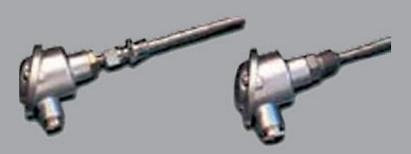
Термопара и термосопротивление, выполненные из кабеля с гибкой уплотненной минеральной изоляцией (MgO), в комплекте с соединительной головкой. Имеется также с раструбом колодца, резьбовым соединением привариваемый.
