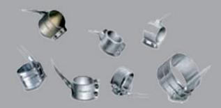
Сопротивления изготовлены с латунной или нержавеющей оболочкой, непроницаемой для всех веществ процесса обработки пластмасс. Большая прочность и высокая плотность Вт/кв.см. являются гарантией быстрого достижения оптимальной рабочей температуры. Кабель питания, зыдерживающий высокую температуру (400°С), защищен дополнительной металлической оплеткой
